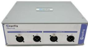
PM 0120 是一款专门针对消费类产品的研发测试设计的调理器, 拥有 2 通道低通 (20~20kHz) 滤波, 测量时减少带外切换信号。适合开关放大器的测量, 采用无源设计, 失真低, 适合测量具有带外噪声的模拟信号。
